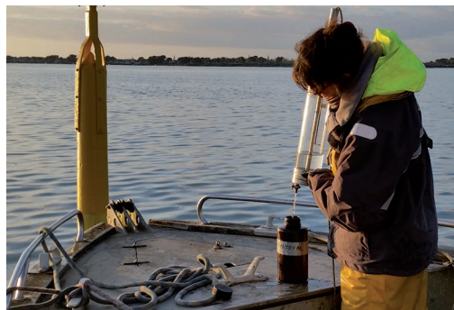
Photos 11 et 12. Remplissage des flacons à partir de la bouteille à prélèvement. À gauche : flacon pour les nutriments. À droite : flacon pour le phytoplancton.
